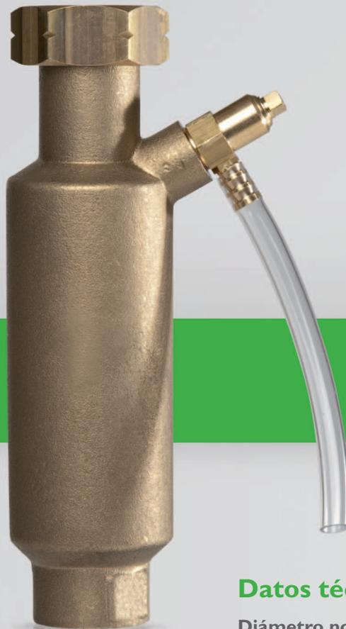
Para funcionar eficientemente, los sistemas de energía solar deben ser purgados con frecuencia. El separador de aire LT20 RESOL ha sido diseñado para purgar de forma continua el aire del fluido caloportador en la línea de impulsión solar. El aire residual se puede purgar manualmente con la válvula de purga y el tubo suministrado.
